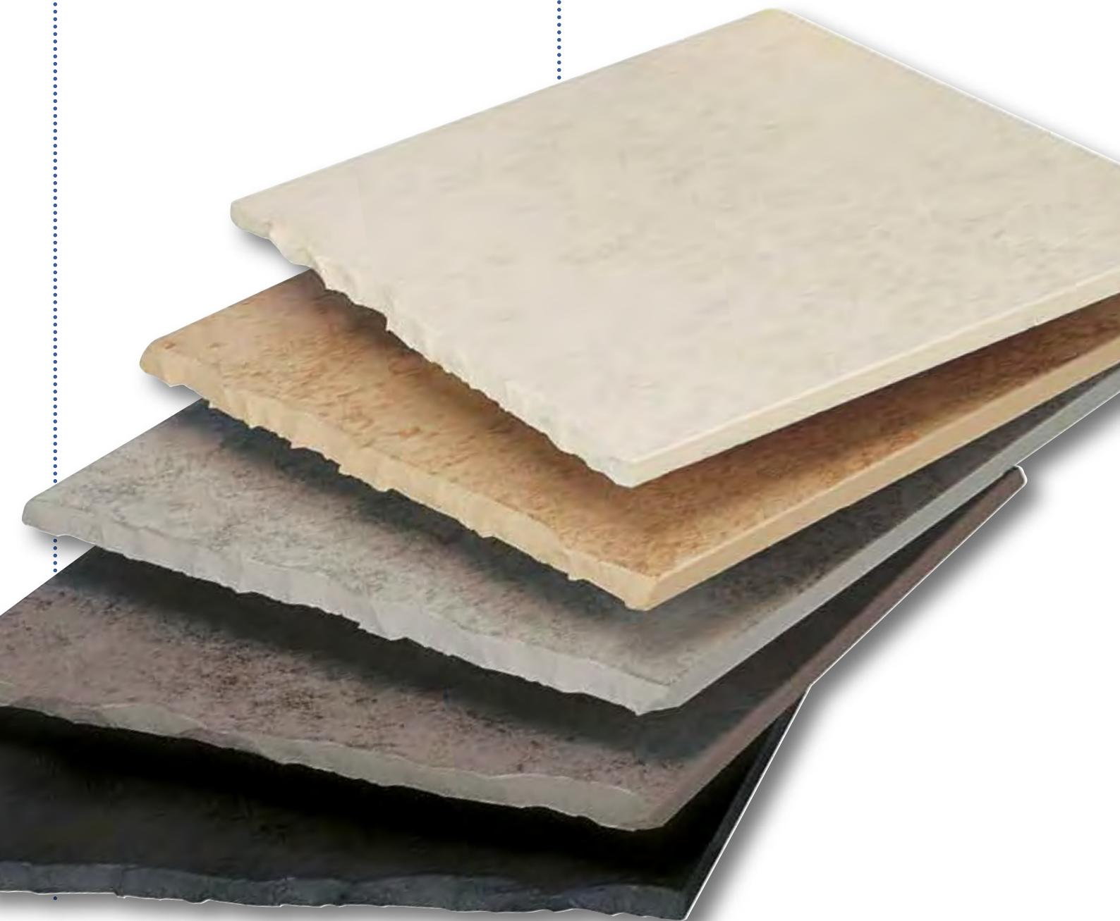
**Il gres porcellanato colorato in massa “SINTESI” è un prodotto ceramico senza eterogeneità nello spessore, ottenuto per impasto, macinazione, atomizzazione, pressatura, essicazione e cottura a oltre 1200°C, di un mix selezionato di materie prime composto da: argille di differenti plasticità, sabbie quarzifere, feldspati (per ottenere un prodotto completamente vetrificato e compatto) e pigmenti a base di ossidi metallici.**
