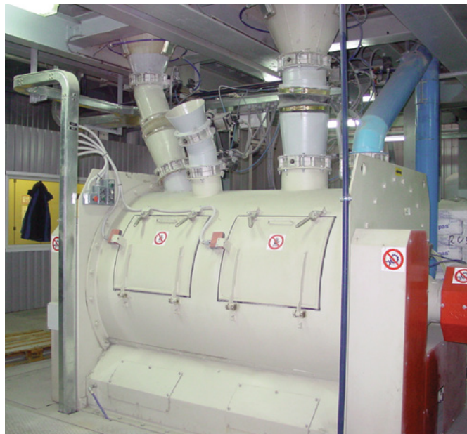
Автоматическое перемешивание исходных сырьевых компонентов
