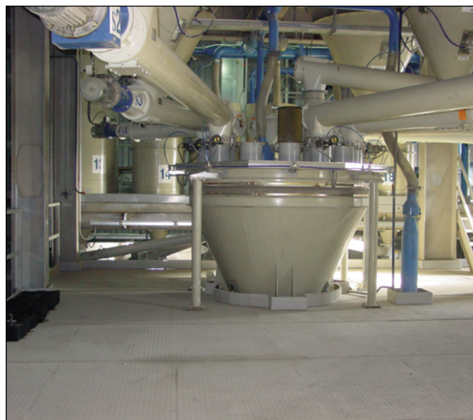
Автоматическое взвешивание и дозировка исходных сырьевых компонентов
